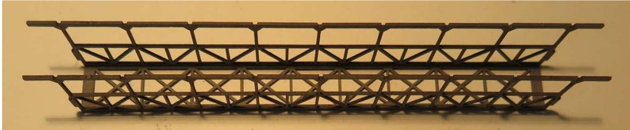
Kleben Sie die beiden Seitenwände. Achten Sie das die Wände unter einem Winkel von  $90^\circ$  geklebt werden.
