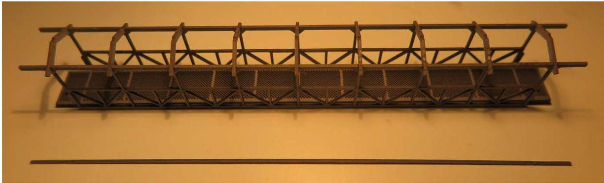
Kleben Sie die Laufbrücke genau symmetrisch im Laufsteg. Benutzen Sie nur sehr wenig Klebstoff an den Seiten, damit die Perforationen der Laufbrücke nicht mit Klebstoff verschmutzt werden.
