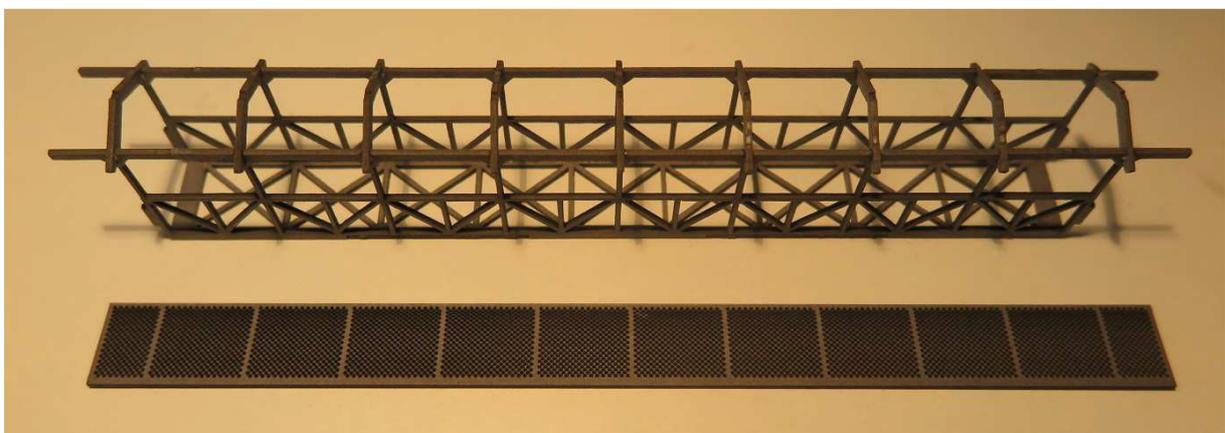
Kleben Sie die Dachreiter. Achten Sie das die Reiter unter einem Winkel von  $90^\circ$  geklebt werden. Benutzen Sie eine Pinzette. Die Reiter passen genau in die Schlitzen der Seitenwänden.
