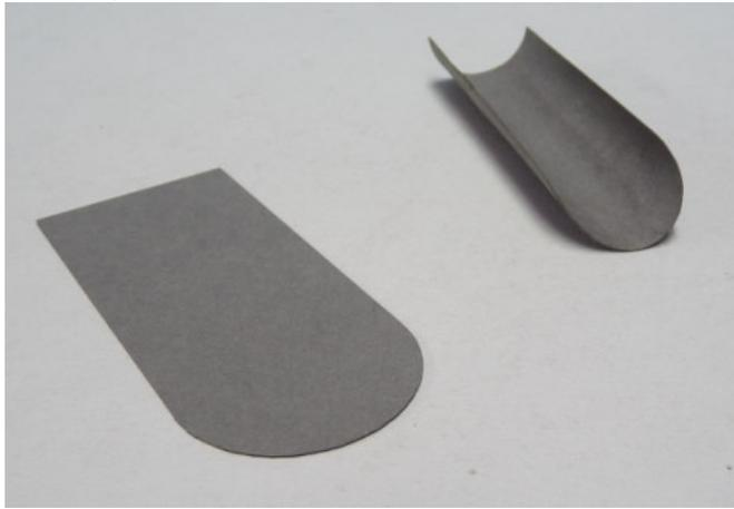
2. ...und über ein passendes Rohr oder Holzstab biegen, trocknen lassen
