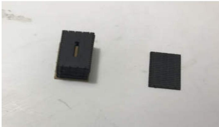
4. erst die längeren Z-Teile, dann die kürzeren unten mit Bodenplatte bündig aufkleben
