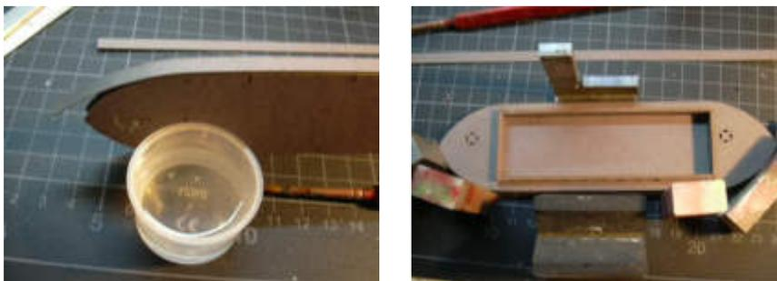
In gleicher Weise wird eine dünne Reeling vorgebogen und auf die Seitenplanke geklebt !
