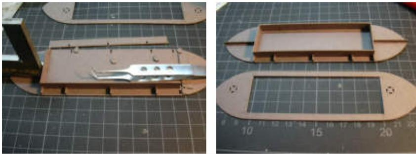
Die Seitenplanken mit einem Pinsel und Wasser anfeuchten und entsprechend der Kontur des Rumpfes mit den Fingern vorgebgen und verkleben; danach am besten mit schweren Gegenständen und/oder Gummis fixieren bis der Leim abgebunden hat. Die Seitenteile sind mit Absicht etwas länger gelassen, um Sie nach der Trockenphase mit einem Skalpell sauber abzuschneiden:
