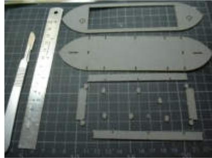
**Die Einzelteile entsprechend der passgenauen Aussparungen mit wenig Leim einsetzen; anschließend das Oberdeck einpassen um Stabilität und winkligkeit zu erreichen:**
